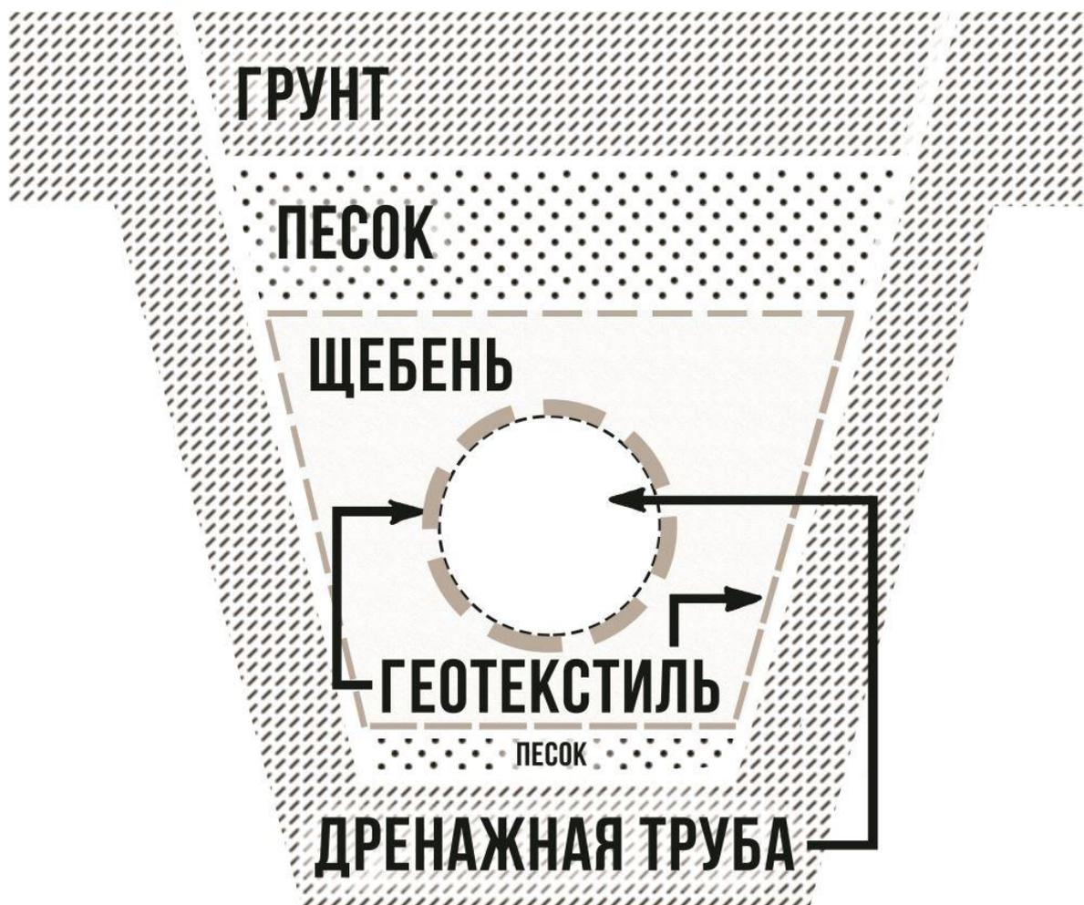
Рис. 2. Разрез дренажа.
